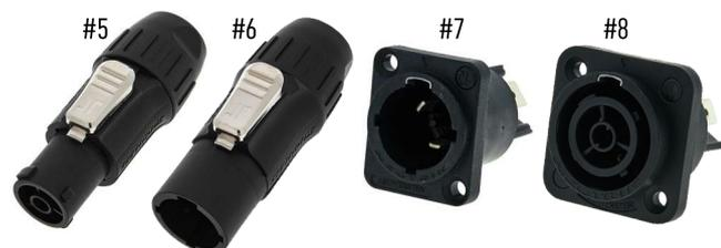
Der Powercon True One Standard von Neutrik ist von der Bedienung ähnlich zum Powercon Standard. Allerdings können die Stecker ineinander gesteckt und somit Kabelwege einfach verlängert werden. Zudem ist die Steckverbindung hingegen zu Powercon (IP44) im gesteckten Zustand bis zu IP64 abgedichtet.
