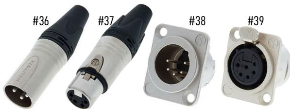
XLR Steckverbinder gibt es in 3 bis 7 Poliger Ausführung. Im Ton werden sie zur Übertragung von Audiosignalen, Analog, sowie AES-EBU Digital, genutzt. In der Beleuchtung hauptsächlich zur DMX Übertragung mit 110Ohm Kabeln.
